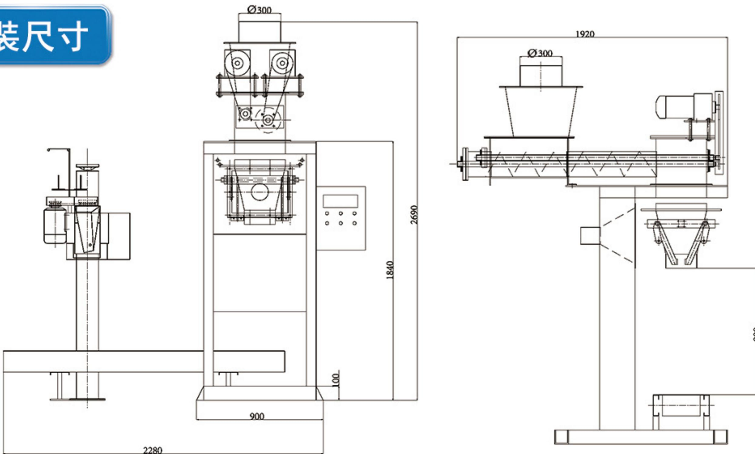
DCS-25F-DF超细粉定量包装机是我公司研发的新一代超细粉包装专用设备，克服了因物料干湿度变化大造成的称量不准、包装速度慢、粘料、冲料等难题，适合包装100-300目的粉状物料。
