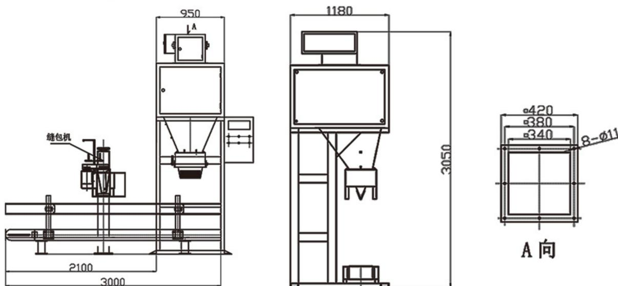
我公司生产的DCS-Z-S定量包装机，速度快，精度高，是集称量、缝口、包装、输送为一体的快速定量包装机组，称量精度不受外界环境的影响，稳定性高，多年来受到广大用户的一致认可。广泛应用于轻工、化工、冶金、建材、港口、矿山、食品、粮食等行业。
